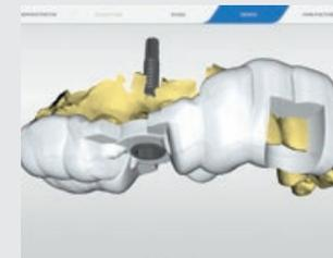
Konstruktion Abutment und Bohrschablone
