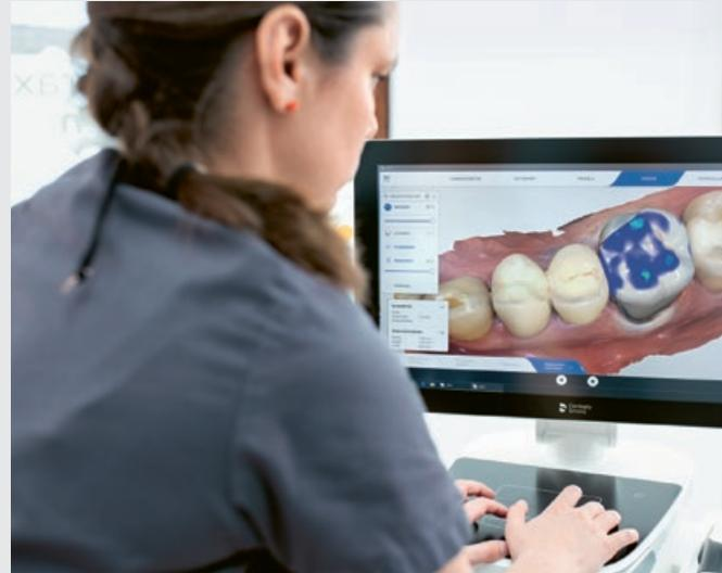
Digitale Spitzenleistung. Der Software-Vorschlag für den Zahnersatz ist äußerst präzise. Nach nur kleinen Korrekturen werden die Daten zur Fertigung an die Schleifeinheit übermittelt.
