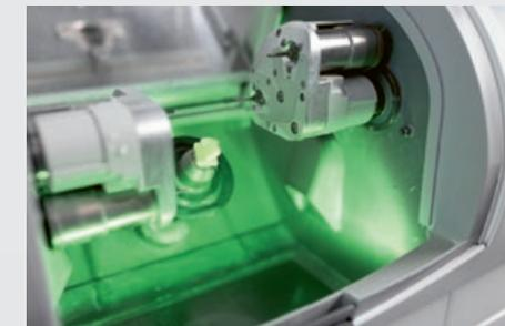
Effiziente Produktion. In gut acht Minuten fräst die Schleifeinheit die Krone aus einem Keramikblock – und das direkt in der Praxis.
