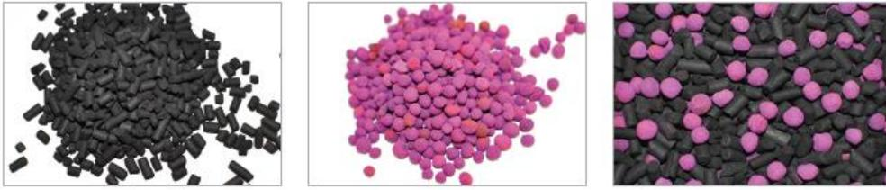
Abbildung 4: Aktivkohlepellets, BAC Granulat, Mischung Aktivkohle & BAC
