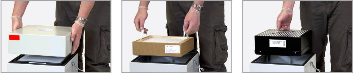
Abbildung 16: Filterwechsel DF 230
