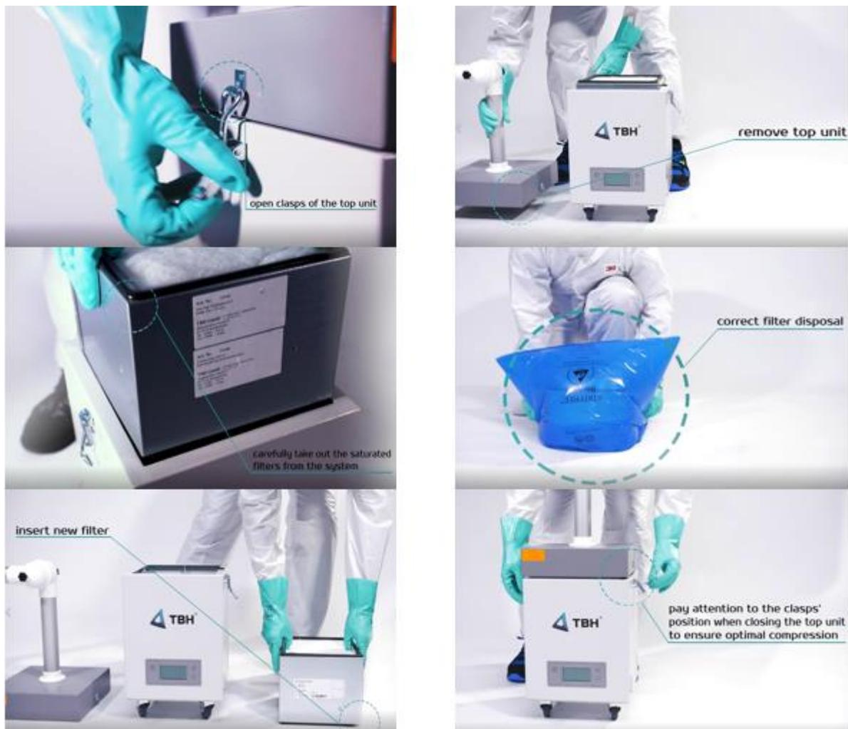
Abbildung 15: Filterwechsel DF 10
